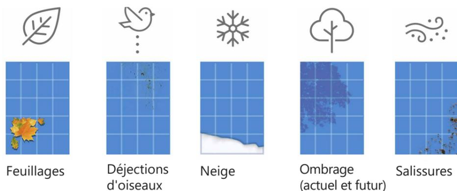
Avec les onduleurs traditionnels, le panneau le plus faible diminue la performance de tous les panneaux. Avec SolarEdge, chaque panneau produit une énergie maximale, et les pertes de puissance sont éliminées.
